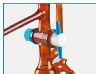
*Все автоматические бюretки оснащены промежуточным краном из PTFE, обеспечивающим надежное, быстрое и точное измерение.*
