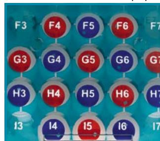
Буквенно-цифровой указатель на рядах пробирок и на крышки обеспечивает простую идентификацию местоположения кювет.
