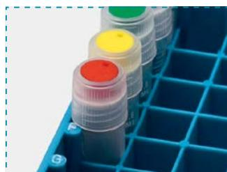
Буквенно-цифровой указатель на рядах пробирок и на крышке обеспечивает простую идентификацию местоположения пробирок.
