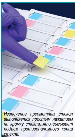
Извлечение предметных стекол выполняется простым нажатием на кромку стекла, что вызывает подъем противоположного конца стекла.
