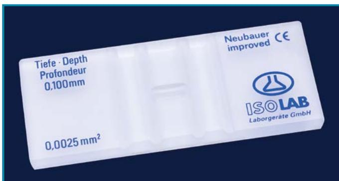
➤ Изготовлены из специального оптического стекла в соответствии со стандартом ISO 12847.
