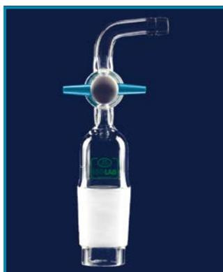
➤ Изготовлены из жаропрочного, химически устойчивого боросиликатного стекла, с изогнутым на 90° адаптером и краном из PTFE.
