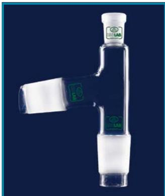
► Изготовлены из жаропрочного, химически устойчивого боросиликатного стекла в соответствии со стандартом DIN 12594, оснащены конусом, наклоненным на 75° вниз.
