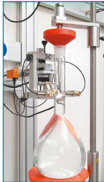
Наполнение заготовок водой выполняется автоматически калибровочными машинами.
