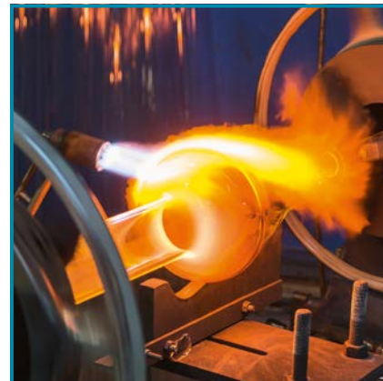
Стеклянные трубки выдуваются высококвалифицированными стеклодувами, что гарантирует однородную толщину стенок, точные размеры в соответствии со стандартами DIN.
