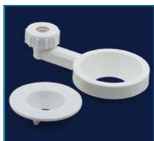
Вороночный держатель без разреза состоит из 2 частей.
